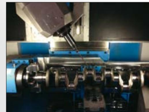
Stufenlos schwenkbare Werkzeugspindel sowie Spannvorrichtung mit Drehmodul und C-Achse, verschiebbaren Reitstock und programmierbarer Lünette zur Unterstützung bei der Bearbeitung längerer Kurbelwellen
