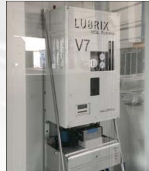
Minimalmengenschmierung für optimale Schnittwerte beim Tieflochbohren, mitentscheidend für hohe Produktivität und kosteneinsparend im Vergleich zur klassischen Anwendung von Hochdruck-Kühlschmierstoffanlagen
