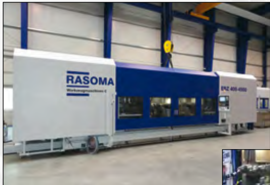
RASOMA Endenbearbeitungszentrum EBZ 400-4500 für wellenförmige Teile bis 4.500mm Länge
