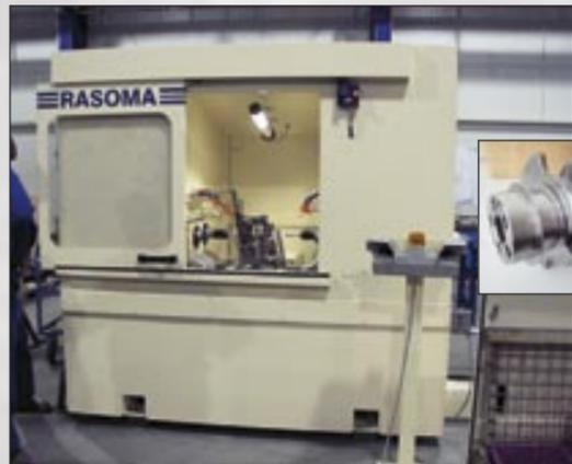
**Sondermaschine zur Bearbeitung von 2 Auswuchtbohrungen  $\varnothing 20$  einschließlich taktzeitneutralem Anflächern an Motorrad-Kurbelwellen**
