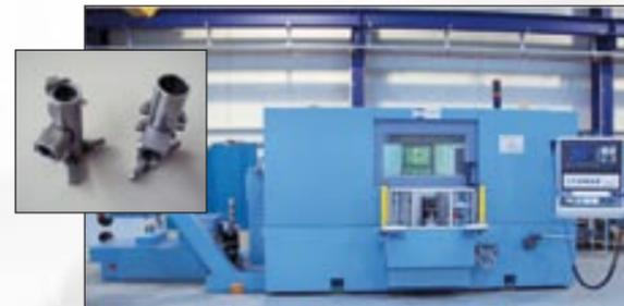
**Sondermaschine zur achsgenauen, dreiseitigen Bearbeitung von Schalthülsen für PKW-Getriebe**
