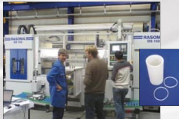
**Anlage zur Komplettfertigung von Dichtringen aus gesinterten Kunststoff für Lenkgetriebe**
