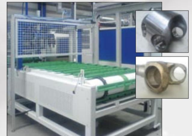
**Sondermaschine zur Bearbeitung der Lagerbohrungen von Mitnehmern und Mitnehmerringen für LKW-Gelenkwellen**
