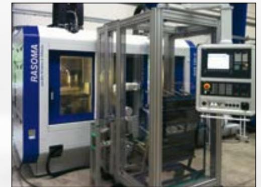
Шарнирный робот для загрузки и разгрузки, а также для подачи на позицию измерения, SPC-лоток и стержневой штабельный накопитель готовых деталей
