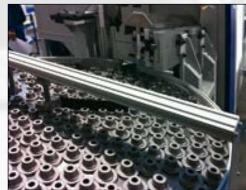
Дисковый накопитель для заготовок и телескопные салазки с переукладчиком
