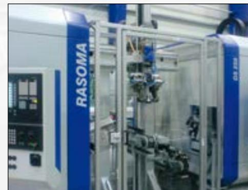
Полностью автоматическая обработка колёсной ступицы на первом и втором зажиме с поворотом детали в грейфере
