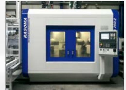
DZS 250-2 с двумя мотор-шпинделями, двумя крестовыми салазками и двумя 12-ти-позиционными вертикальными револьверными головками для симультанной обработки 1-го и 2-го зажима
