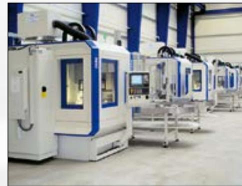
Линия из десяти попарно установленных станков DS 250 с овальным накопителем для мягкой и твёрдой обработки зубчатых колёс для транспортных средств
