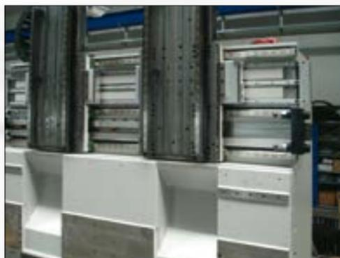
Основная конструкция станков DZS, здесь с двумя крестовыми салазками на 3 линейных направляющих с линейным двигателем между ними
