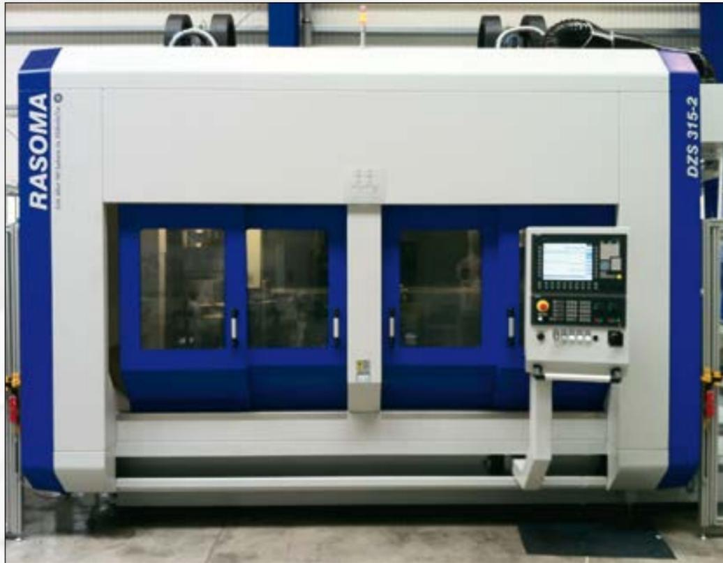
DZS 315-2 с двумя сверлильно-фрезервальными обрабатывающими узлами и 12-ти-позиционной револьверной головкой VDI 50
