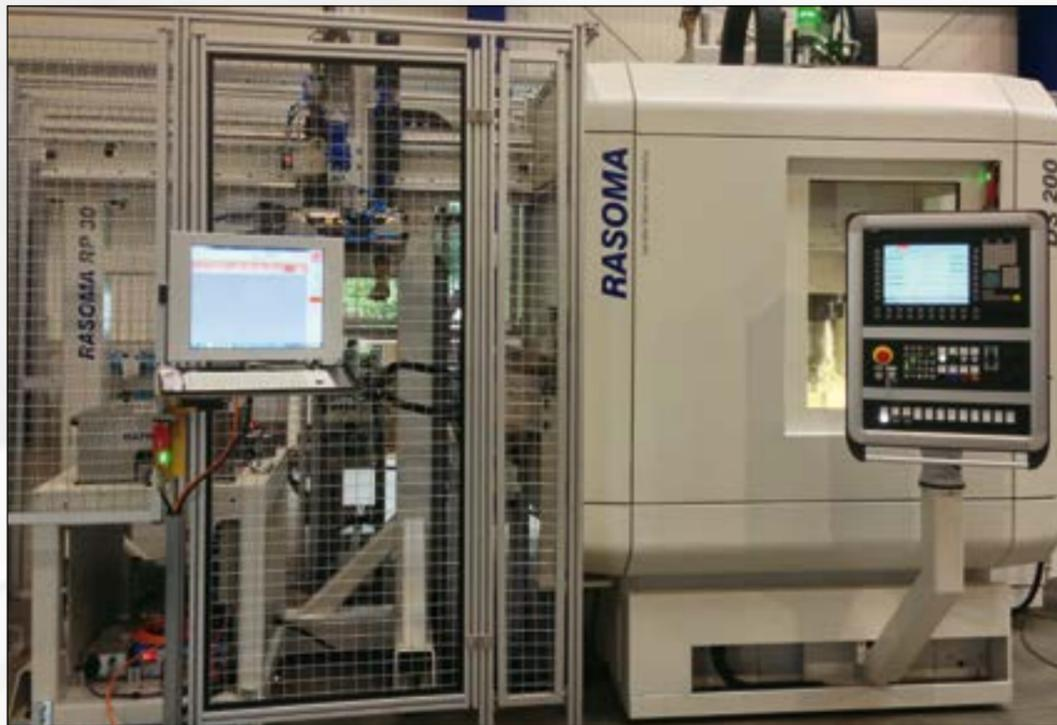
DS 200 с конвейером подвода и отвода деталей, портал RP 30 РАЗОМА, а также внешнее измерительное устройство (окраска согласно техусловиям)
