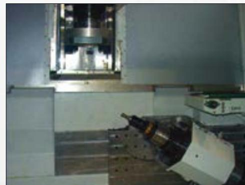
Сверлильно-фрезерный шпindel с регулировкой угла в станке DZS 315
