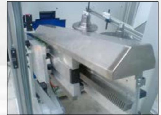
Телескопные салазки фирмы Разома для подвода и отвода деталей
