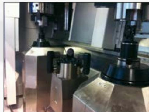
Симультанная обработка корпусов муфт на двух обрабатывающих узлах одного станка DZS 315-2
