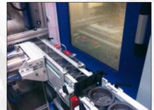
Конвейер подвода заготовок с дефлектором для предотвращения неправильного вложения деталей
