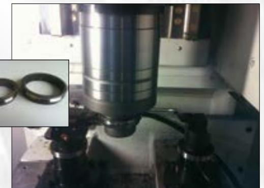
DZS 250-2 с блочным инструментом для синхронной обработки закалённых скользящих втулок
