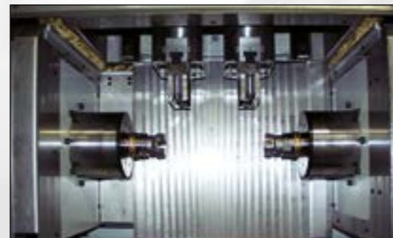
Исполнение с мотор-шпинделями вместо корончатой револьверной головки
