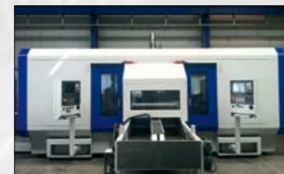
EBZ 60-900 с подачей и отводом деталей через центр машины
