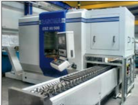
Торцеобрабатывающий центр РАЗОМА EBZ 60-500 с непрерывным тактовым конвейером для заготовок и готовых деталей
