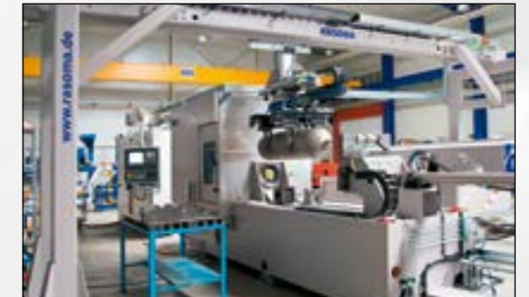
Загрузка и разгрузка EBZ 250-1000 линейным порталом РАЗОМА с вертикальной осью и большим подъёмным грейфером с 360° поворотным модулем
