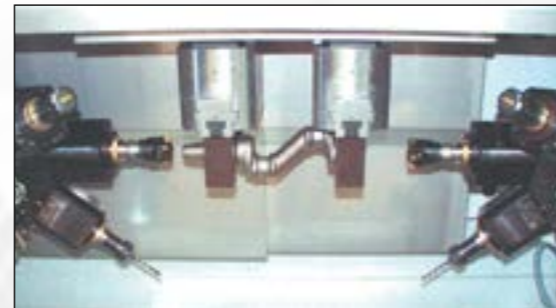
6-ти-позиционная корончатая револьверная головка центра EBZ 60-500
