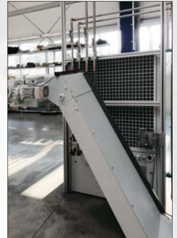
Klimagerät und Späneförderer
