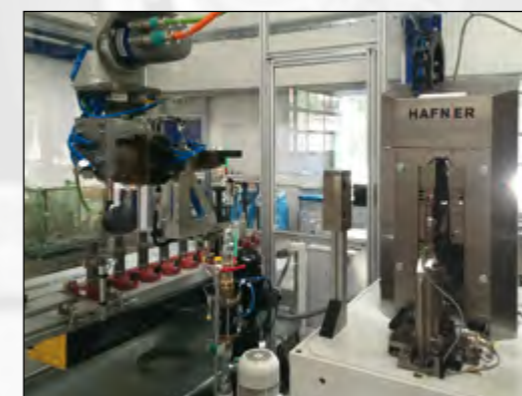
Maschinenintegriertes RASOMA-Knickarm-Ladeportal und Messstation
