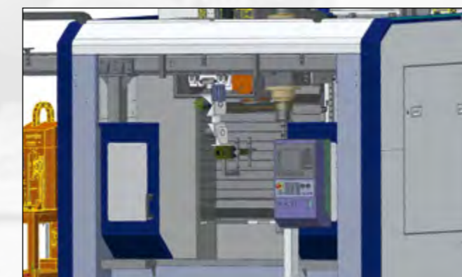
Prinzip der Be- und Entladung von wellenförmigen Teilen mit dem maschinenintegrierten RASOMA-Knickarm-Ladeportal
