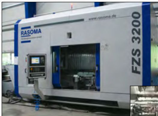
RASOMA Fertigungszentrum FZS 3200 zur Endenbearbeitung und zur Bearbeitung der Ölbohrungen u.s.w. an Kurbelwelle
