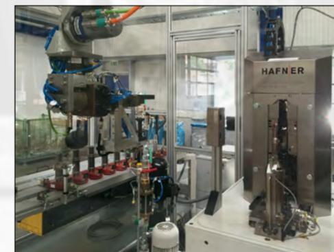
Maschinenintegriertes RASOMA-Knickarm-Ladeportal und Messstation
