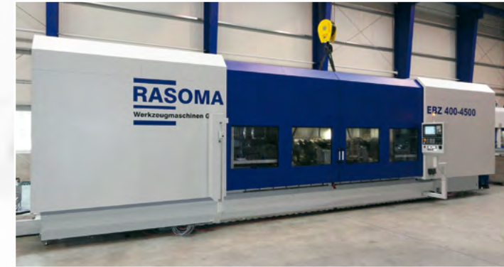
RASOMA Endenbearbeitungszentrum EBZ 400-4500 zur Bearbeitung wellenförmiger Teile bis 4.500mm Länge
