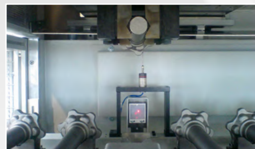
Messtaster am Zuführband zur Bestimmung des Nullpunktes am Rohteil
