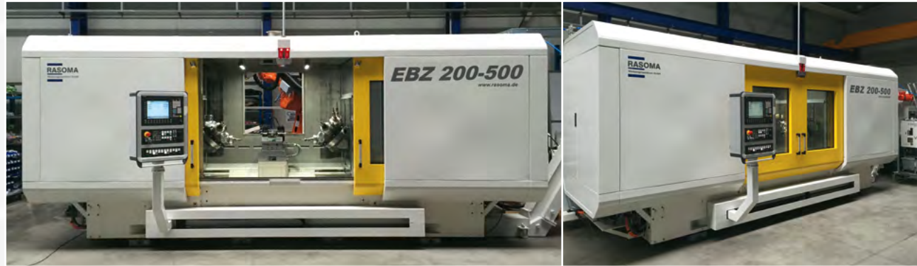
Das hochproduktive RASOMA Endenbearbeitungszentrum EBZ 200-500, hier mit Roboterbe- und -entladung
