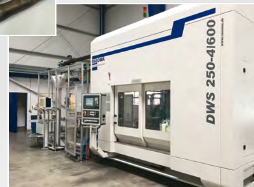
RASOMA Senkrecht-Wellendrehzentrum DWS 250-4 mit automatisierter Werkstückzu- und -abführung
