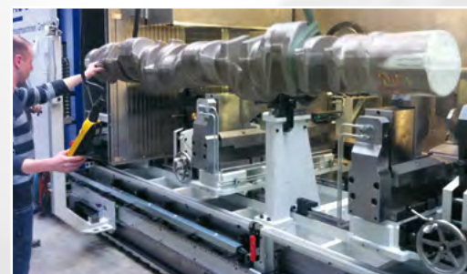
Einlegen einer Großkurbelwelle in ein EBZ 400
