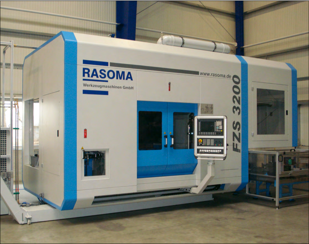
Unser neu entwickeltes, modular aufgebautes CNC Fertigungszentrum FZS 3200 ist speziell geeignet zur Bearbeitung der Ölbohrungen und Gewichtserleichterungsbohrungen von Kurbelwellen oder ähnlicher wellenförmiger Teile bis 1.150 mm Länge.
