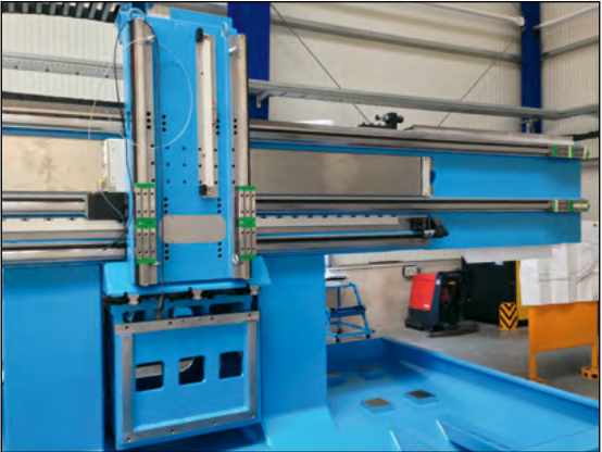
Grundgestell der Maschine mit dem Längsschlitten auf drei Linearführungen, Querschlitten für hängende, schwenkbare Werkzeugspindel, unten der Y-Schlitten mit den Anschraubflächen für die Spannvorrichtung
