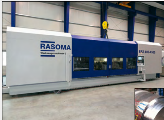
EBZ 400-4500 zur Endenbearbeitung von Großkurbelwellen bis 4.500 mm Länge
