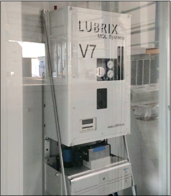
Minimale Mengenschmierung für optimale Schnittwerte beim Tieflochbohren, mitentscheidend für hohe Produktivität und kosteneinsparend im Vergleich zur klassischen Anwendung von Hochdruck-Kühlschmierstoffanlagen
