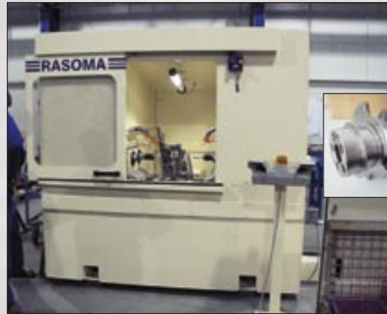
Sondermaschine zur Bearbeitung von 2 Auswuchtbohrungen Ø20 einschließlich taktzeitneutralem Anflächern an Motorrad-Kurbelwellen
